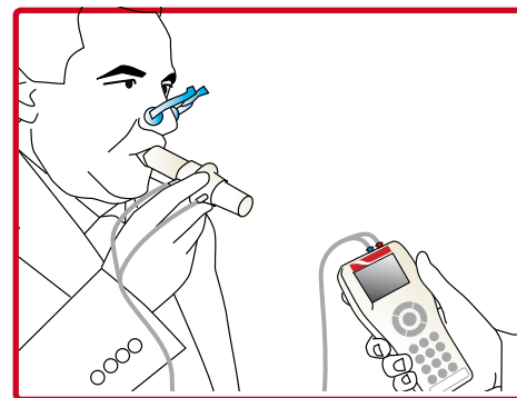
Il flussimetro è collegato all'unità, consentendo di verificare la manovra spirometrica in tempo reale.
